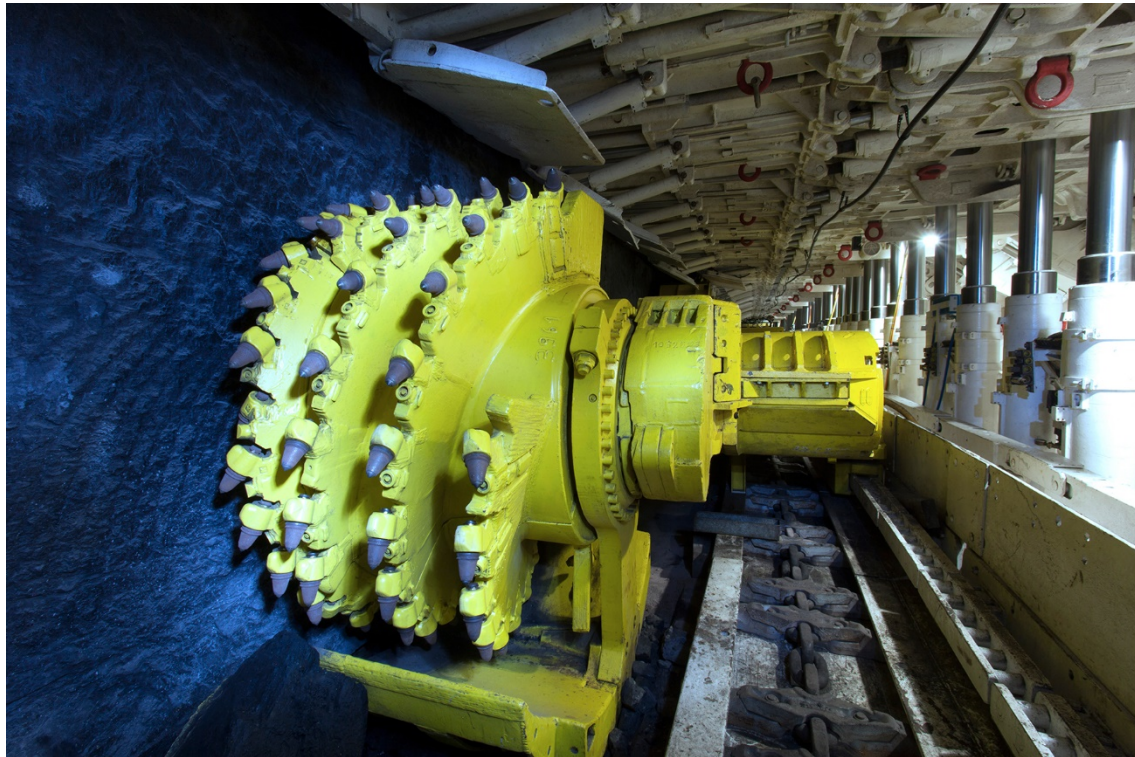
WALZENSCHRÄMLADER IM ANSCHAUUNGS- BERGWERK DES DBM (BAUJAHR ETWA 1980, 230 X 258 X 1040 CM) FOTO: KARL HEINZ JARDNER
