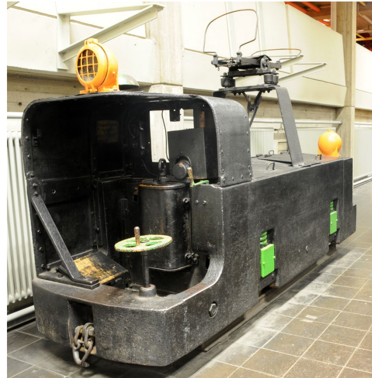
FAHRDRAHTLOKOMOTIVE FÜR HAUPTSTRECKEN (BAUJAHR CA. 1902, 200 X 98 X 330 CM, 5,4 TONNEN)
